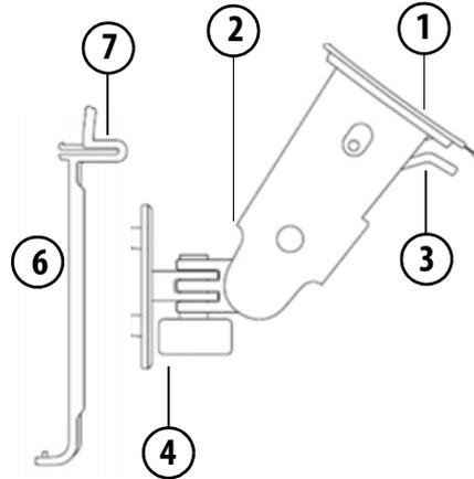
Abbildung ähnlich, bei Geräten mit Magnethalter entfällt die Entriegelungstaste ⑦.
