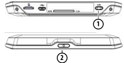
Bei Geräten ohne die Taste ① an der Geräteunterseite (modellabhängig): Mit der Taste ② können Sie das Gerät Einschalten, ausschalten oder in den Schlafmodus versetzen.
