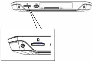
Der Karteneinschub befindet sich an der Geräteunterseite. Das Kartenfach ist mit einem federbetätigten Rast- und Auswurfmechanismus ausgerüstet.
